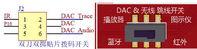
图 4 DAC 输出及蓝牙兼容开关
