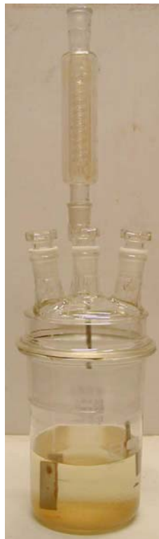
图 37.4.2: 带回流冷凝器的接触容器
