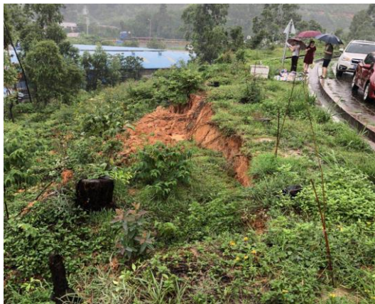
照片 3 滑坡后缘变形特征，镜 SE
