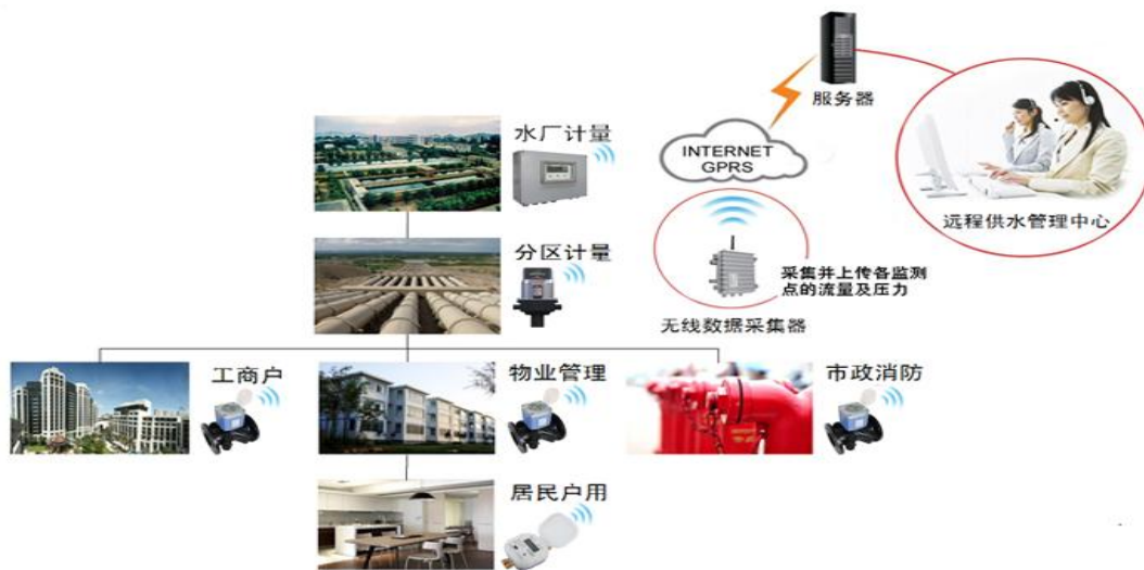
图 21: 汇中股份供水计量管理系统
