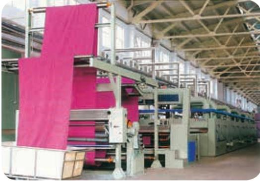
适用于多种纺织面料整理，对针织物和机织物脱水、后整理、烘干、拉幅和热定形
