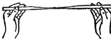
图 2-4 玻璃管的拉细
