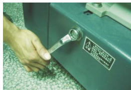
图 6-4: V 形带的调整图二
