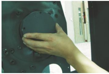
图 3-6: 轴承盖板安装示意图
