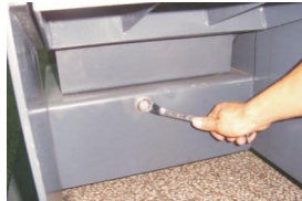
图 6-3: V 形带的调整图一
