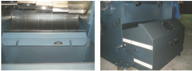
图 3-8: 筛网、网架及集料盒安装
