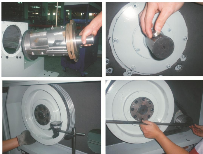
图 3-7: 轴承、电机、带轮及皮带安装
