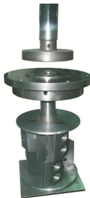
图 3-5: 轴承座及轴承安装示意图
