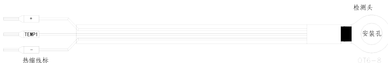
图4 温度传感器的外形与端子定义
