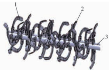
图2 六头螺旋秸秆还田耕整机刀辊结构图
