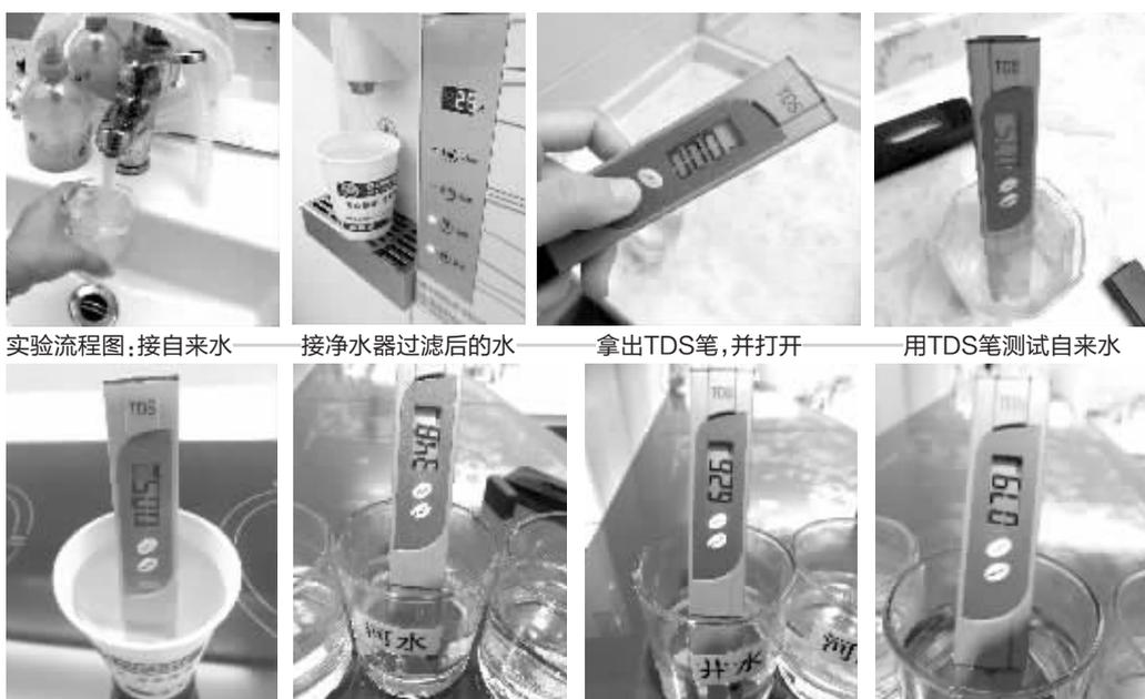
实验流程图：接自来水——接净水器过滤后的水——拿出TDS笔，并打开——用TDS笔测试自来水——用TDS笔测试过滤水——用TDS笔测试河水——用TDS笔测试井水——用TDS笔测试烧开的水
