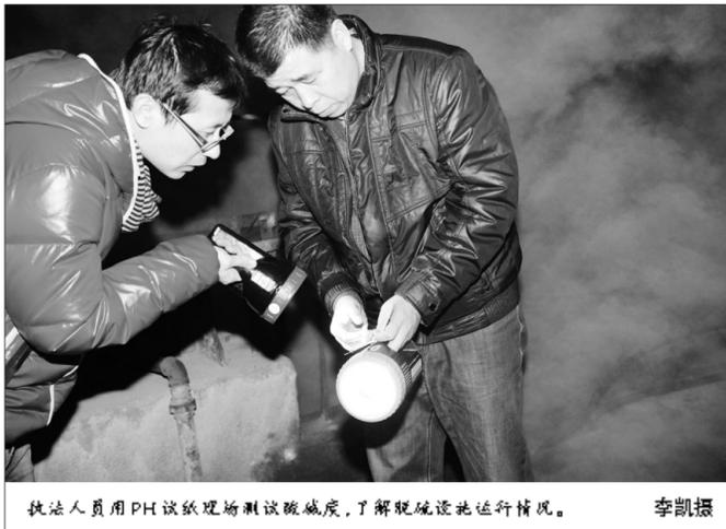
执法人员用PH试纸现场测试酸碱度,了解脱硫设施运行情况。李凯摄
