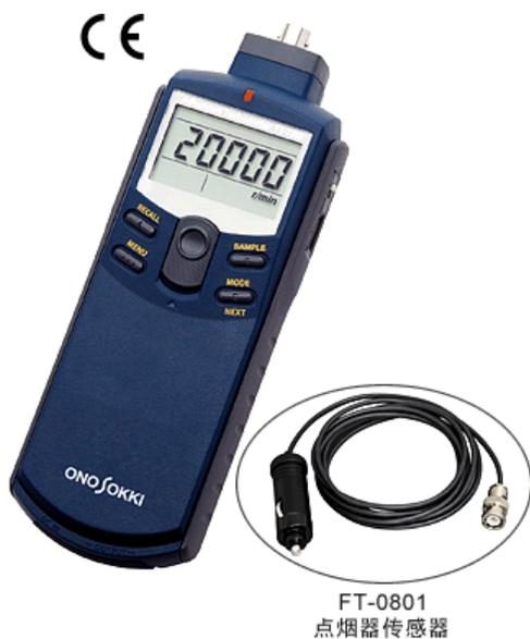
FT-7200高性能FFT式手持转速表是一种小型、使用方便、高性能的手持式数字转速表。电机及各种旋转机械等发生的噪声或振动及磁场的变化等信号，FT-7200通过FFT(高速傅立叶变换)的运算，测量出其转速。对于声级计或振动传感器来的复杂信号，也能提取相当于转速的频率成分，运算显示转速。
