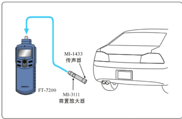
通过汽车消音器排气噪声进行发动机转速测量。消音器排气噪声内包含有发动机的转动起因的脉动成份，由此脉动成份的频率值，可测出发动机的转速。
