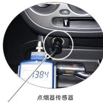
使用传声器与前置放大器组合·加速度传感器的发动机转速测量
