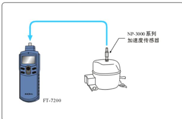
空调器，电冰箱用压缩机的转速测量。压缩机没有转动轴，可以使用加速度传感器，利用旋转产生的振动测量压缩机的转速。
