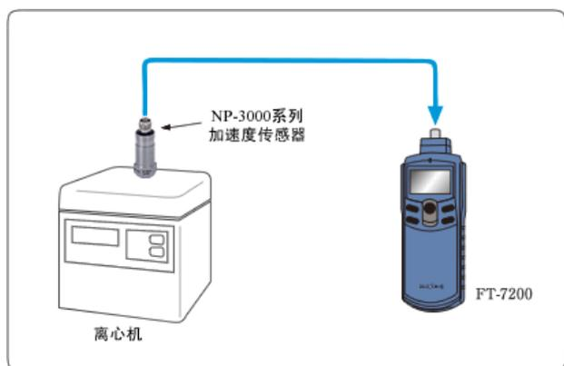
离心机的转动轴位于机器的内部，不能通过反射贴片的方式进行转速测量。但，使用FT-7200可以与加速度传感器配套，可以测量离心机的转速。将加速度传感器设置在离心机的机盖部，测量由转动产生的振动成分。FT-7200采用FFT分析的计算处理方法，可稳定的进行转速测量。
