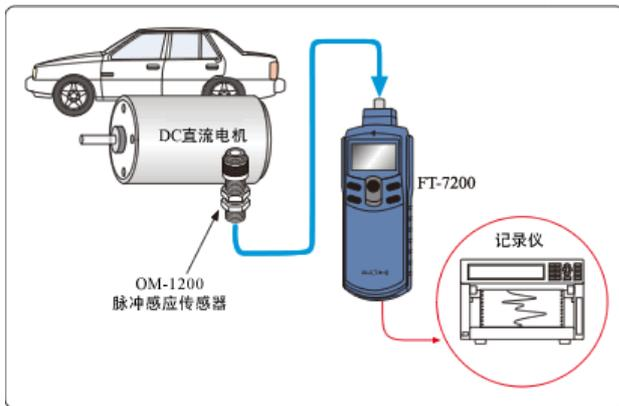
DC直流电机在各种领域广泛被使用，近年来伴随这电动汽车的发展，车用直流电机的转速测量也越发重要。在这里，使用OM-1200脉冲感应传感器与直流电机垂直设置，通过直流电机的漏磁效应进行检测，FT-7200测出转速值。通过模拟电压信号输出可转速的变化记录到记录仪，也可用于对转速信号的确认。
