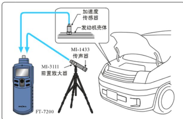
利用由发动机汽缸内活塞运动引起产生的噪声和振动，可以测量发动机的转速。发动机被壳体包住，不能使用发动机转速传感器时，可使用这种方法。
