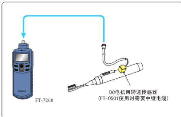
可用于家用电器制品内藏DC电机的转速测量，如电动牙刷等。通过内部的DC电机的漏磁测量转速。
