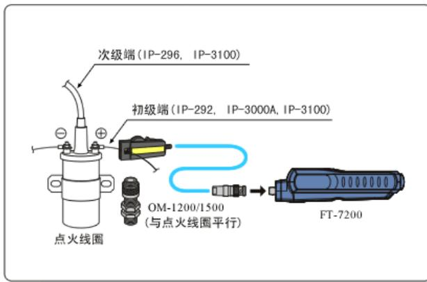
利用汽车发动机点火机构的特征测量转速。测量时将传感器设置在点火线圈的初级端或次级端，并设定1转的点火次数。脉冲数可根据1转所对应的点火·爆发次数设定。
