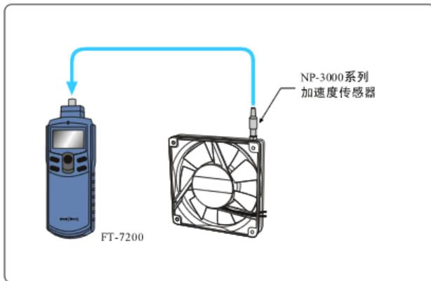
小型风扇的转速的转速测量。旋转体的振动与旋转运动相关。通过测量振动的频率，即可算出旋转体的转速。
