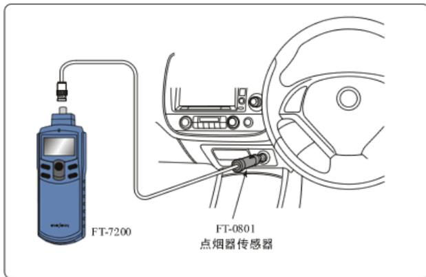
通过车辆电源插口(Power Outlet)，通过对发动机的点火产生的车载电源电压噪声信号进行检测，测量出发动机的转速。
