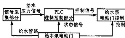
图1 给水泵自启动控制系统框图
