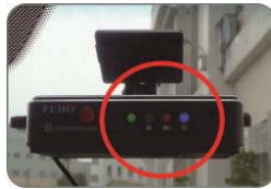
綠燈:電源 藍燈:GPS 定位確定
