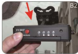
將主機支架循著卡榫滑入固定卡住
