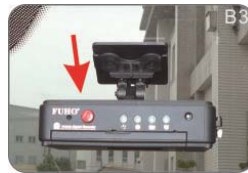
將主機支架循著卡榫滑入固定卡住
