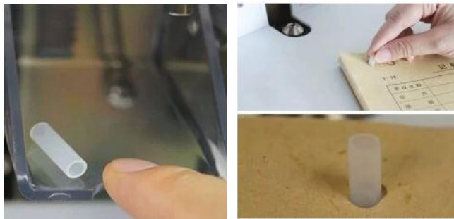
图 1-6 将铆管插入孔眼
