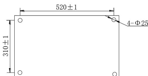
图3 信号机底部安装孔尺寸 1 (小尺寸)
