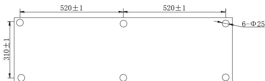
图4 信号机底部安装孔尺寸 2（大尺寸）
