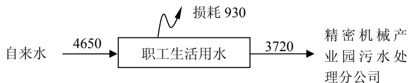
图 5-2 扩建项目水平衡图 单位: t/a
