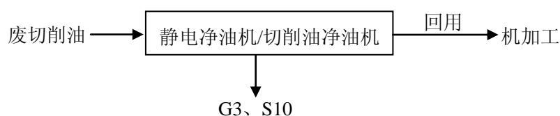
图 5-2 废切削油回收处理工艺流程图
