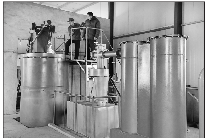
江苏省宜兴市芳桥镇金兰村积极建设秸秆气化集中供气站,450多户农户用上了自己种出来的“煤气”。图为操作人员正在秸秆制气车间点火制气。 丁焕新摄
