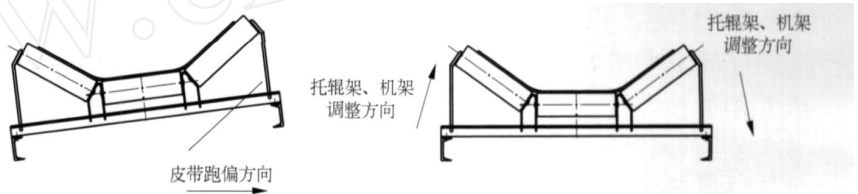
图 3 托辊架中心线偏差示意图
