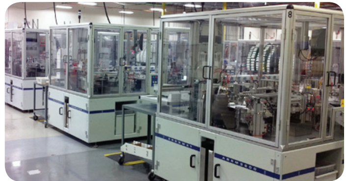
Netflix DVD 退货设施车间内的 ARRM3600 设备。每个 ARRM 3600 检测站每小时可以对 3600 个邮件封套进行读码和检测。
