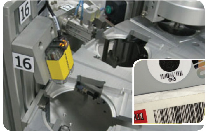
DataMan 读码器进行定位，以读取条码。
