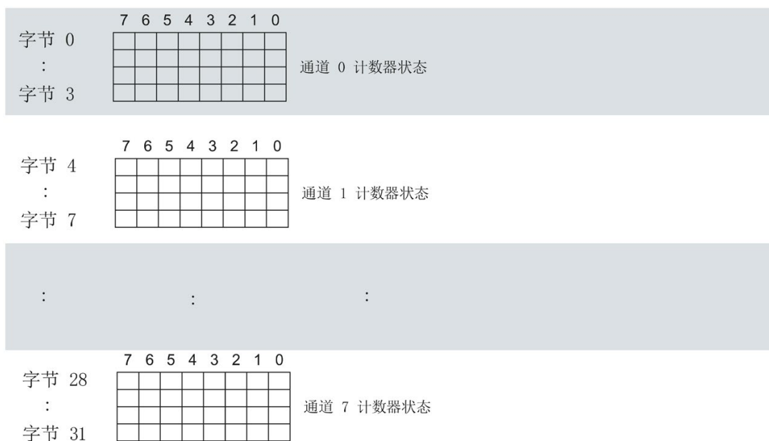
图 B-2 数据集 129 的结构：字节 0 到 31
