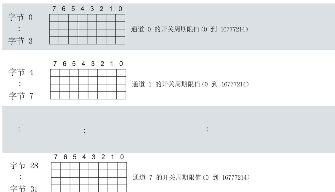
图 B-3 数据集 130 的结构：字节 0 到 31
