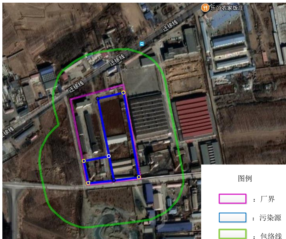
图 7 项目卫生防护距离包络线图
