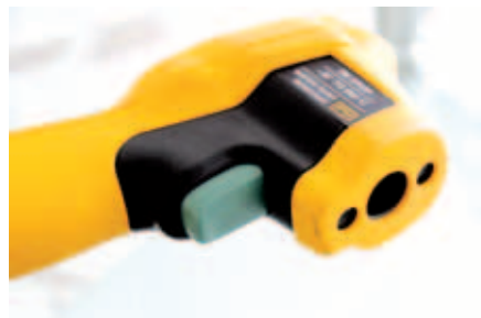
图2 2束定位激光的发射口
