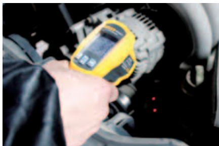
图5 测量散热器进水管温度
