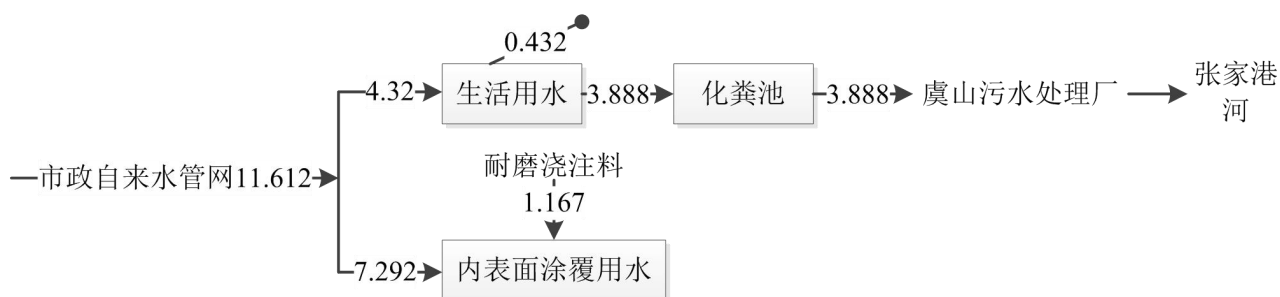
图 1-1 本项目给排水平衡图 单位：m 3 /d
