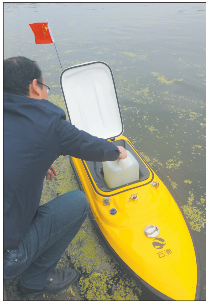
湖北省随州市水质采样又添新装备。一艘黄色无人采样船在市环境保护监测技术人员的遥控下,首次在沮水大桥断面水面上采集水样。无人采样船不仅能实现标准化地表水采样,还能在应急监测的情况下开展腐蚀性物质污染的水体水样采集工作。图为监测人员从采样船中取出采集的水样。李翠 邱海杰摄
