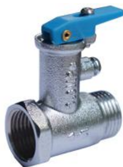
排气安全阀 (开启压力 \approx 0.1\text{Mpa} , 内外螺纹 G1/2)
