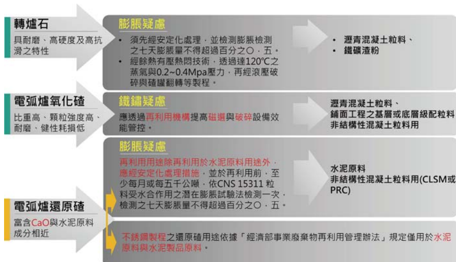
圖 5 鋼爐渣處理要件與資源化用途歸類
