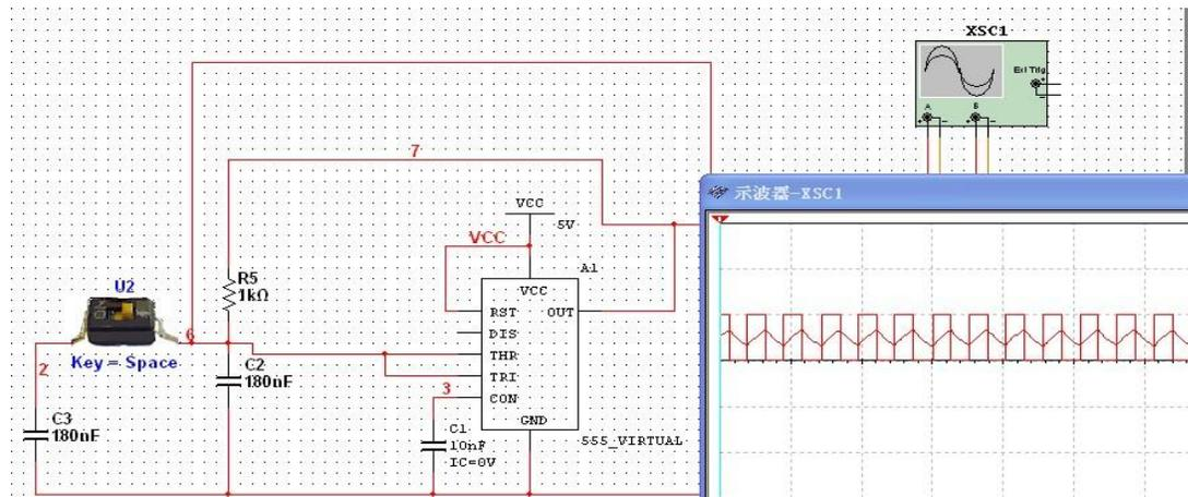
从硬件仿真上可看出，随着外部电容的变化，内部方波的频率也在变化。
