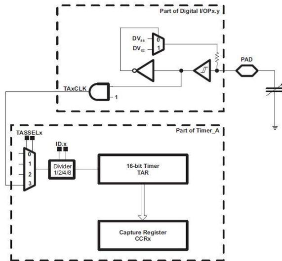
这是从 datasheet 上 GPIO 部分截取描述具有电容检测功能 IO 引脚的介绍，通过配置 Px.xSEL 管脚（es: 把 P1.6 设置为电容检测引脚 P1SEL &= ~BIT6; P1SEL2 |= BIT6; 相应引脚的第二功能设置见 datasheet slas722e P38），使能电容检测硬件，到此，触摸屏的硬件设计工作已经全部完成。
