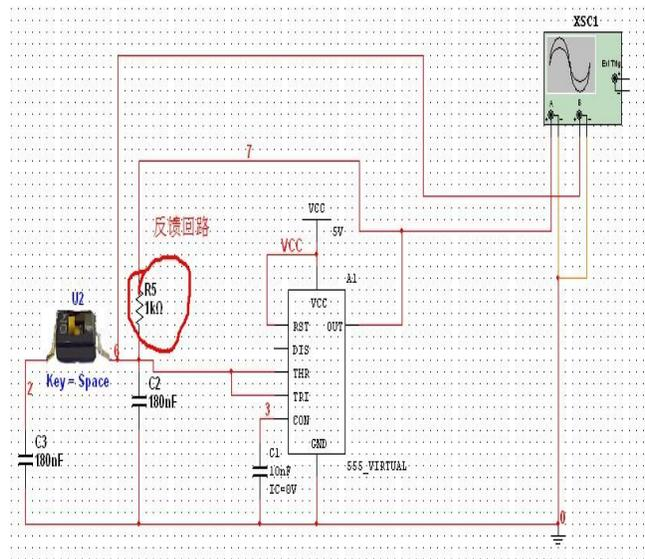
NE555 内部正好由一个施密特触发器和反相器构成的一个集成芯片，短接 P2 和 P6 外挂一电容，并且把 555 输出反馈回输入管脚，构成一震荡电路，C2 上的波形如下所示：
