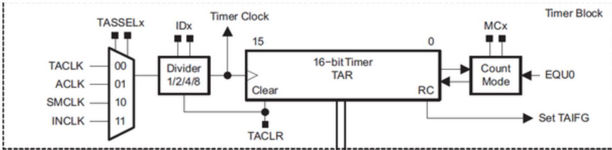
首先来下 TIMERA 的时钟源：TA<sub>x</sub>CLK 是定时器时钟，定时器时钟的选择我们可以通过配置寄存器 TASEL<sub>x</sub>，一般我们不会用到 INCLK 这路时钟，而在电容检测上，使能内部 OSC 输入，就会在 MSP430 内部史密斯触发器后端产生 INLCK 信号，其频率即为外部电容和内部上拉电阻构成的 RC 震荡电路的频率。
