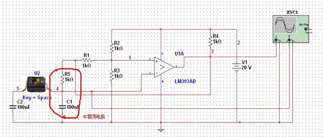
其原理就是测震荡电路频率，关键参数在电容----C1 的充放电，R5 和 C1 构成一阶 RC 震荡电路。比较器的输入电压时随着输出电压变化而变化的，而比较器负输入端电压是由 C1 充放电决定。通过计算可以发现，电容电压在  $1/3V_{CC}$ - $2/3V_{CC}$  之间反复变化。其震荡频率和比较器输出频率保持一致，这样，通过检查比较器输出波形的频率就可以知道我们输入电容的容值。当输入电容发生变化的同时,输出频率也会改变:
