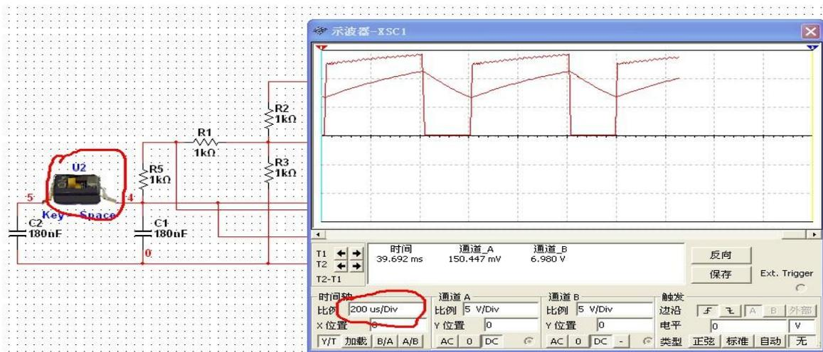
利用该原理可以在 MSP430 外搭若干 RC 电路和内部比较器可以完成比较器方波频率的检测。
