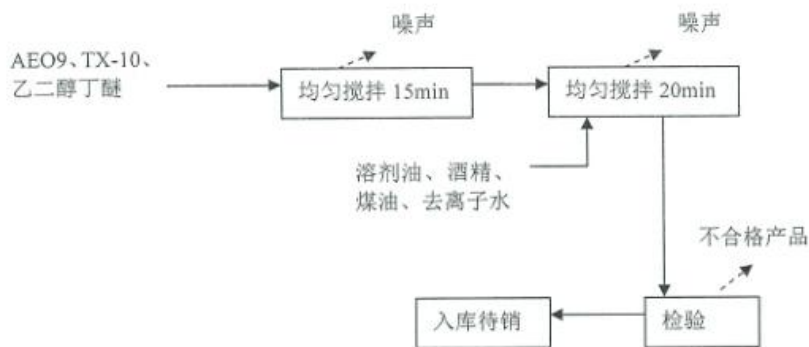
图 1-3 去油王洗涤剂生产工艺流程图
