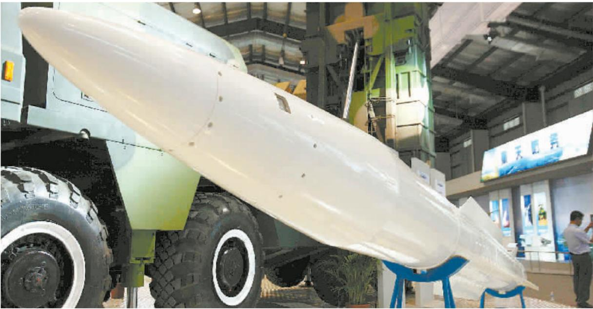
图为我国航天科工集团自主研发的神鹰400制导火箭武器系统。这一系统可发射8联装SY400制导火箭弹，满足不同纵深、不同毁伤能力的打击需要。新华社发
