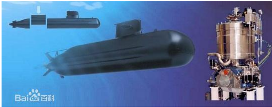
图 42：711 所研制的 SE/AIP 热气机系统（斯特林发动机）
