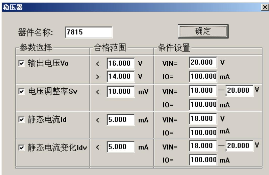
7.4.3 测试：按入、地、出和 E、B、C 对应关系插好，确定接触良好后选择菜单中“测试”或单击工具栏上
