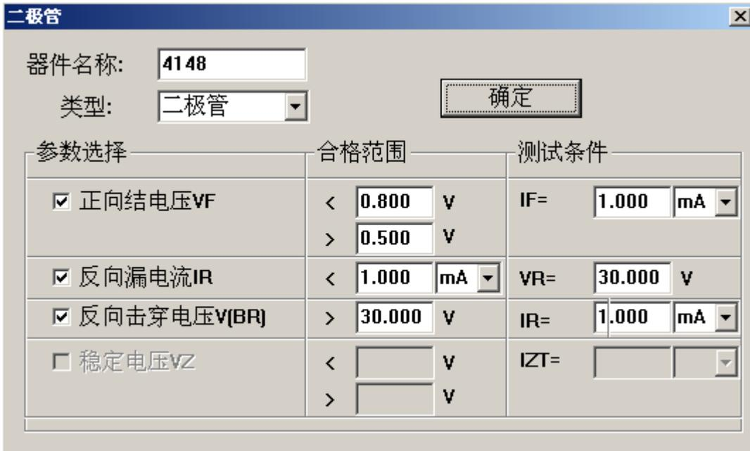
7.3.3 测试：将二极管插到插座的 B-E 之间，确定接触良好后选择菜单中“测试”或单击工具栏上
