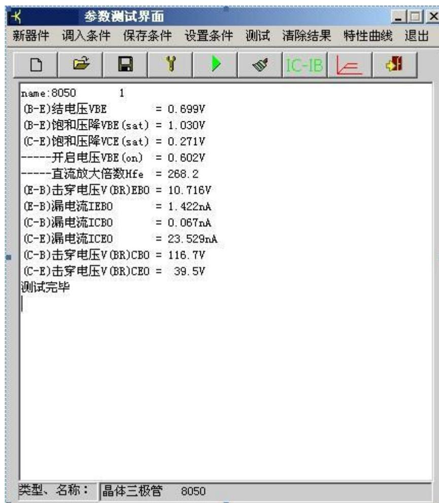
7.1.5 对库中没有的晶体管要按照手册进行填写测试条件，具体过程参看“8050.dat”中的“条件设置”。
