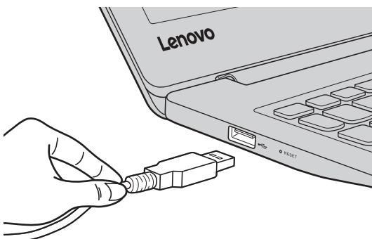
首次将某一 USB 设备插入计算机上的特定 USB 端口时，Windows 将自动为该设备安装驱动程序。安装驱动程序之后，将不再需要执行任何其他步骤即可断开或连接该设备。
