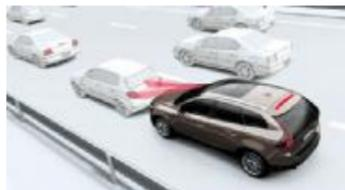
防撞系统侦测与前车之间的距离并自动控制速度或刹、停车。图片来源:百度图片
