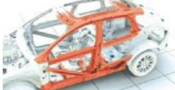
沃尔沃XC60侧面防撞结构示意图。图片来源:百度图片
