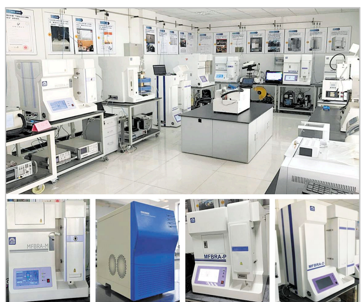
图5创新研发的系列微型流化床反应分析及快速过程质谱
