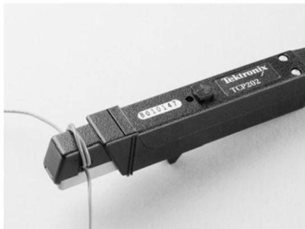
图2.8. 分芯AC电流探头实例。在探头上把导线绕 n 圈可以使有效的灵敏度提高 n 倍。
