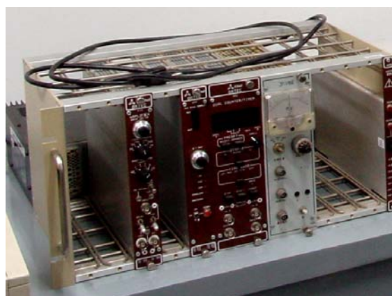
图四 探测器主放及电子学参数设定插件
