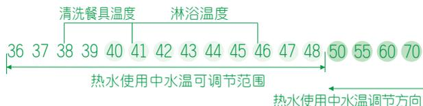
注：高温设置或低温设置时，因季节差异进水温度过低或过高时，可能无法达到所设定的最高温度或最低温度，请参照水温调节方法调整进水量，或适当调整您的设定温度。
