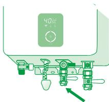
请定期清洗滤网组合，以免水杂质堵塞滤网组合，造成机器无法启动。
