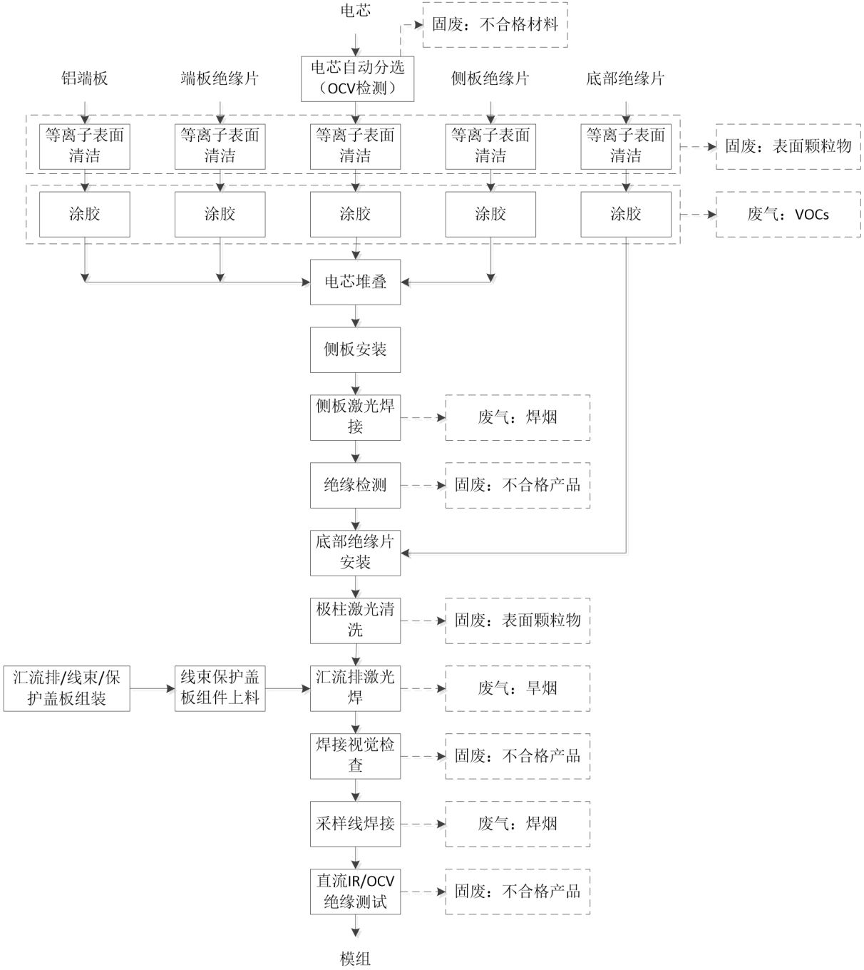
图 5-2 电池模组组装工艺及污染工序产生流程图
