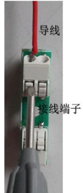
图 b 接线板接线方法
